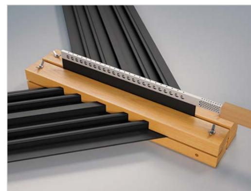
– Установите нагревательный элемент в рабочее положение между концами гидрошпонок. Плавнo сомкните кондуктор, подводя концы гидрошпонки к нагревательному элементу. При этом вдоль всего периметра среза шпонки образуется валик из расплавленного материала. Следите за тем, чтобы оплавление происходило равномерно.
