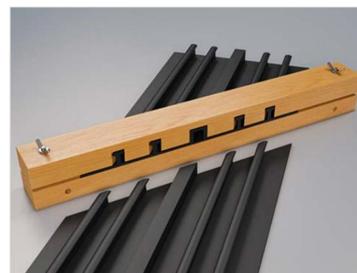
– Разожмите кондуктор и вставьте шпонку таким образом, чтобы она немного высывалась из кондуктора и снова зажмите.
