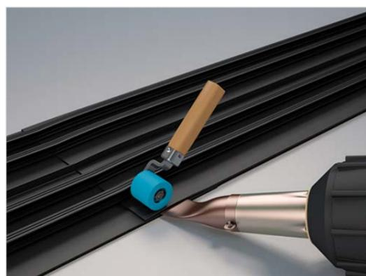
– Введите насадку в сформированный нахлест и сварите гидрошпонки, прижимая верхнюю шпонку к нижней тefлоновым роликом.
