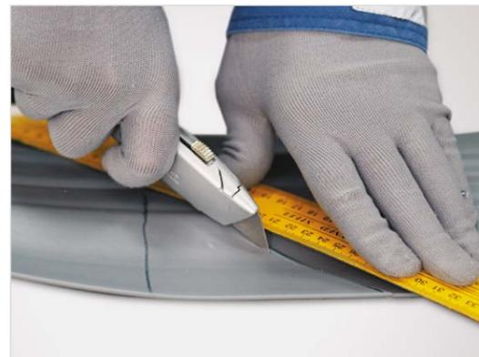
– После того как заготовка обрезана под **45°**, переверните ее и подрежьте у крайних ребер по **1 см** в глубину и в стороны, как показано на рисунке.
