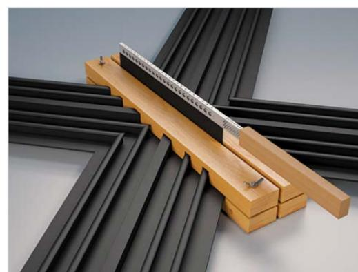
– Зафиксируйте выполненные детали в специальном кондукторе для крестообразных стыков. Установите нагревательный элемент в рабочее положение между концами гидрошпенок. Плавнo сомкните кондуктор, подводя концы гидрошпонки к нагревательному элементу. При этом вдоль всего периметра среза шпонки образуется валик из расплавленного материала. Следите за тем, чтобы оплавление происходило равномерно.
