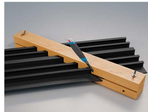
– Установите и зафиксируйте соединяемые гидрошпонки в кондукторе для угловых соединений и подрежьте их вдоль него под углом **45°**.
