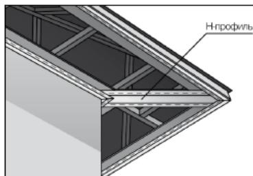
с. Установка Н-профиля, предназначенного для соединения панелей в угловых зонах.
