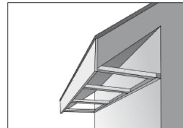
а. Устройство каркаса под обрешетку. Для этого необходимо установить брусков на фасаде по уровню нижнего края свеса крыши. Затем установить бруски, соединяющие фасад и свес крыши. Бруски между собой соединить при помощи металлических уголков и пластин.
