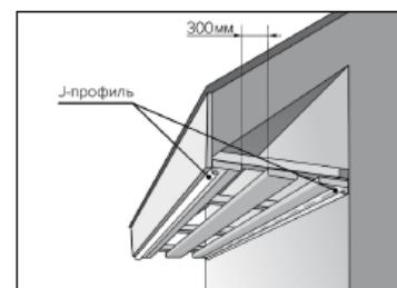
б. На бруски смонтировать обрешетку. В качестве обрешетки рекомендуется использовать доску 100 x 25 мм. По краям свеса монтируется направляющий профиль (J-профиль).
