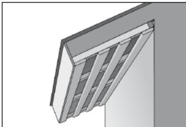
а. Монтаж обрешетки под установку панелей и направляющих. Две доски обрешетки монтируются по краям свеса, остальные доски монтируются с шагом 300 мм.
