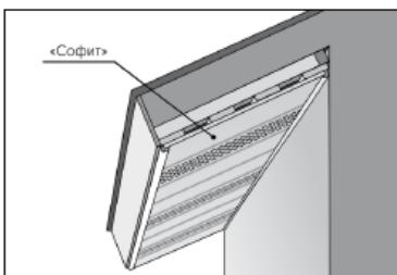
с. В направляющие профили вставляются панели и фиксируются при помощи саморезов к обрешетке.
